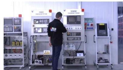
Wir verfügen über von uns entwickelte Prüfstände, mit denen wir prüfen, ob das Gerät funktionstüchtig ist. Sie sorgen dafür, dass SIEMENS 6AV6 642-0DC01-1AX0 OP177B repariert wird.
