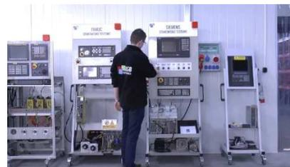
Wir verfügen über von uns entwickelte Prüfstände, mit denen wir prüfen, ob das Gerät funktionstüchtig ist. Sie sorgen dafür, dass FANUC A20B-1003-0120 repariert wird.
