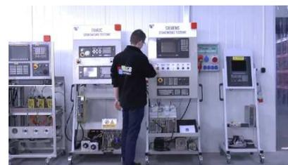
Wir verfügen über von uns entwickelte Prüfstände, mit denen wir prüfen, ob das Gerät funktionsfähig ist. Sie sorgen dafür, dass INDRAMAT A.C.SERVOCONTROLLER TDM1.2-50-300W1-S0102 repariert wird.
