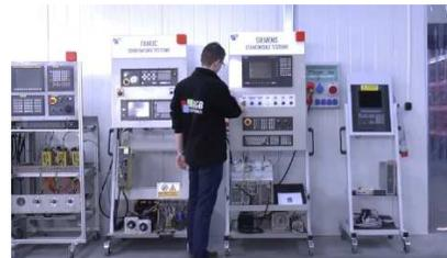
Wir verfügen über von uns entwickelte Prüfstände, mit denen wir prüfen, ob das Gerät funktionsfähig ist. Sie sorgen dafür, dass BOSCH DM004K1101-D repariert wird.
