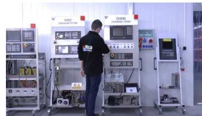
Wir verfügen über von uns entwickelte Prüfstände, mit denen wir prüfen, ob das Gerät funktionstüchtig ist. Sie sorgen dafür, dass YASKAWA USAREM-05CE2K repariert wird.
