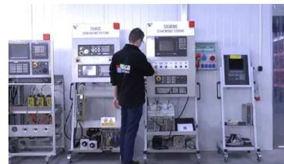
Wir verfügen über von uns entwickelte Prüfstände, mit denen wir prüfen, ob das Gerät funktionsfähig ist. Sie sorgen dafür, dass OKUMA CN-CRP-6 OPUS 5000-II CRPB-II XPS-442A 1911-164 repariert wird.
