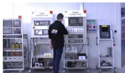
Wir verfügen über von uns entwickelte Prüfstände, mit denen wir prüfen, ob das Gerät funktionstüchtig ist. Sie sorgen dafür, dass SIEMENS 6ES7414-1XG02-0AB0 repariert wird.
