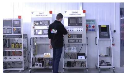
Wir verfügen über von uns entwickelte Prüfstände, mit denen wir prüfen, ob das Gerät funktionstüchtig ist. Sie sorgen dafür, dass SIEMENS 6ES5 420-8MA11 repariert wird.
