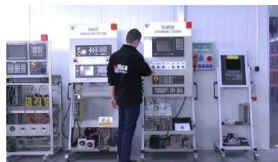
Wir verfügen über von uns entwickelte Prüfstände, mit denen wir prüfen, ob das Gerät funktionstüchtig ist. Sie sorgen dafür, dass SIEMENS 6ES5252-3AA31 repariert wird.
